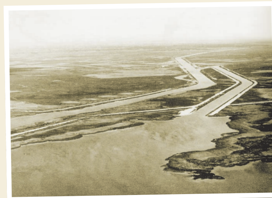
Skjern Å efter reguleringen. Bogen dokumenterer, at Hedeselskabet allerede dengang udmærket godt vidste, projektet havde en begrænset levetid på grund af jordsenkning, når man dræned. Man fortalte det bare ikke til nogen.
